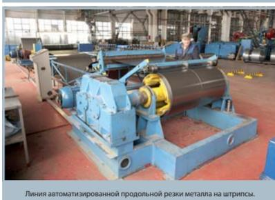
Линия автоматизированной продольной резки металла на штрипсы.
